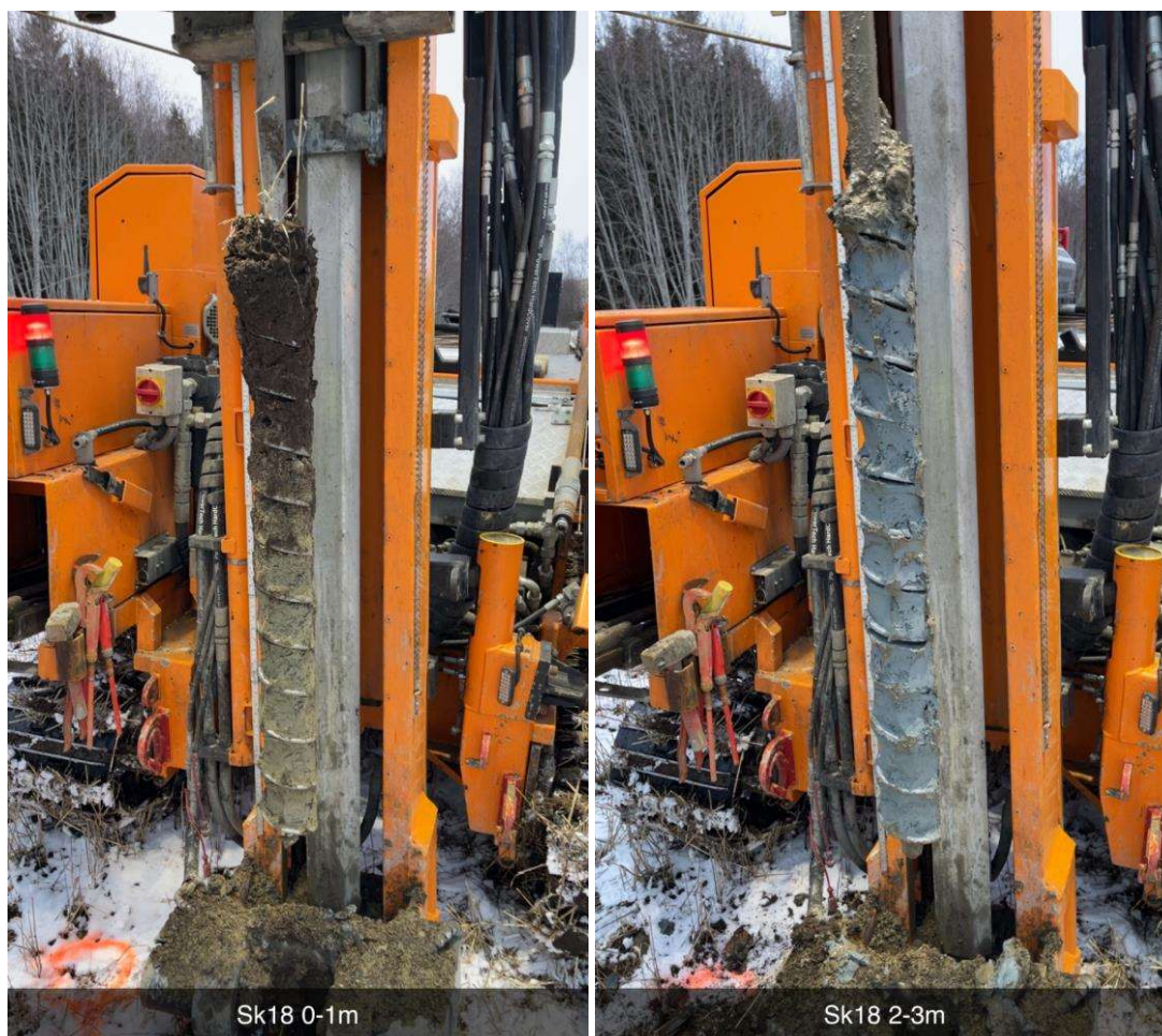
Figur 3-7: Jordprofil fra prøvepunkt 18. Venstre: Mørk brun matjord (A-sjikt) og omrørt silt og leire(B-sjikt). Høyre: Tettpakket, homogen silt (C-sjikt). Foto: Liv Hermanrund, Multiconsult.
