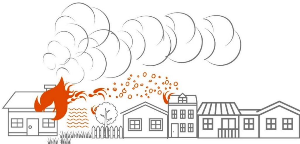
Figur 4: Illustrasjon av brannspredning som følge av stråling, flammekast og flyvebrann.
