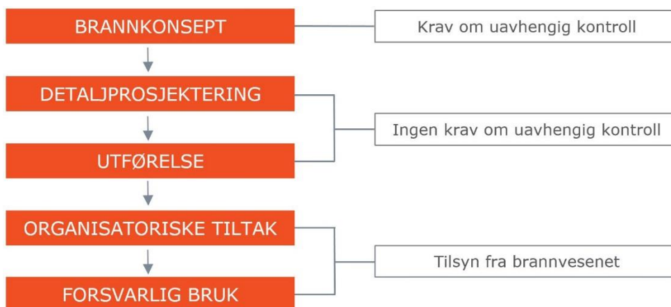
Figur 20: Illustrasjon av branntekniske sikkerhet i bygg ivaretatt gjennom ulike faser, med og uten tilsyn/kontroll.
