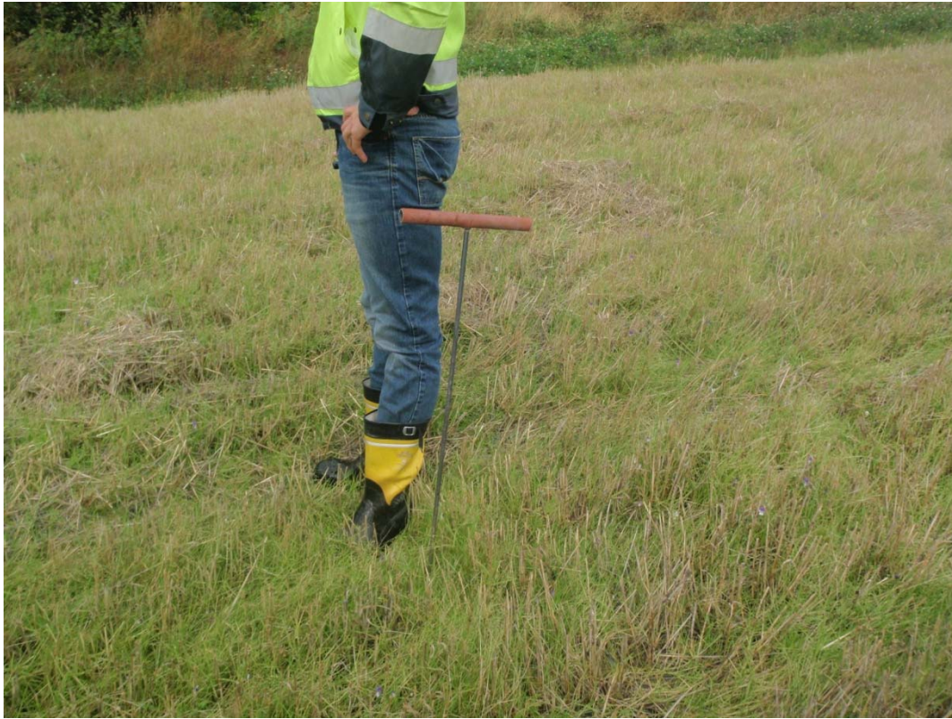
Bilde 4. Geo stang stoppet på stein.
